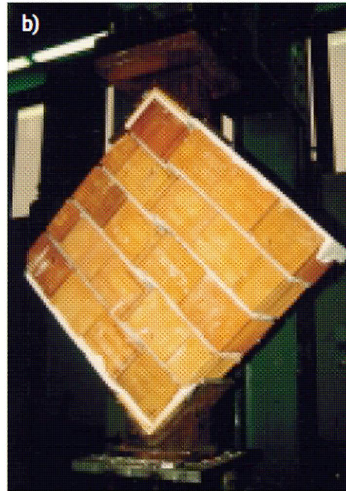
8. Prove a compressione diagonale: rottura dei blocchi nel pannello  $A_s$  (a); rottura dei giunti nel pannello  $A_t$  (b).
